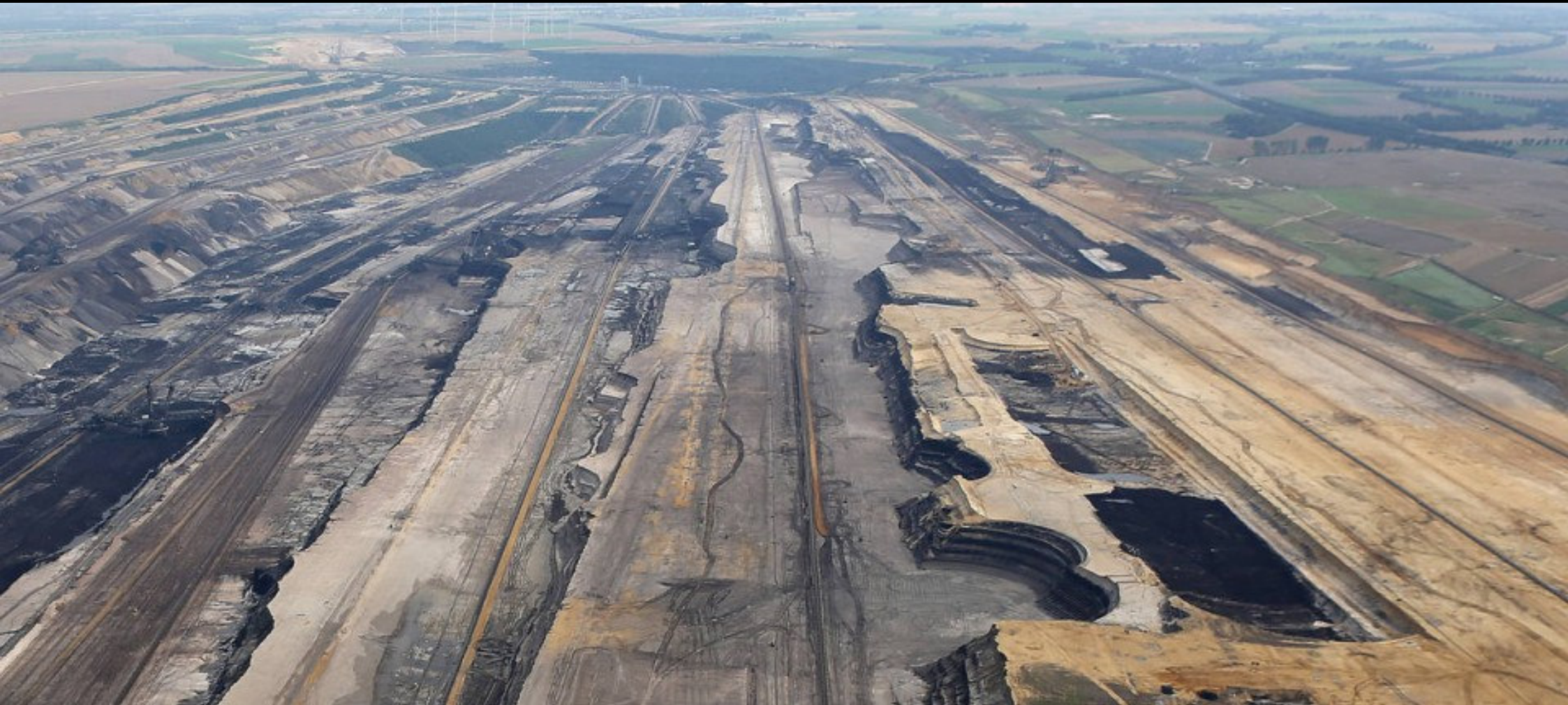
Tagebau Garzweiler (Bild: dpa): 30 km 2 , >400m tief, 9m Kohle, 200Mt Abraum, 25Mt Kohle
